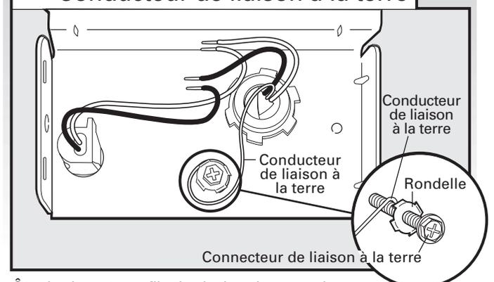
Ôter la vis verte; enfilez la vis dans la cosse du conducteur vert de liaison à la terre. Réinstallez et serrez la vis verte.
